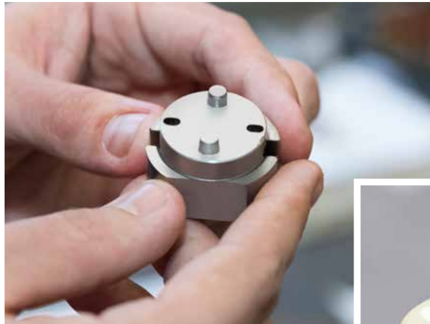
Vorrichtung zum Drahterodieren von Formeinsätzen. Auch wenn es um Kleinstserien geht, kann HT Tooling schnell auf Kundenwünsche reagieren.
